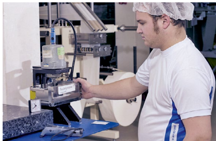
Dichtheitsstest eines Sachets.
